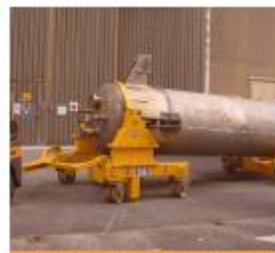
Le traitement des 11 pièges froids qui servaient à purifier le sodium secondaire (6 mètres de long, 5 tonnes)
